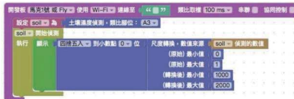
圖 4 土壤濕度傳感器資料顯示程式(Webduino 官網)
