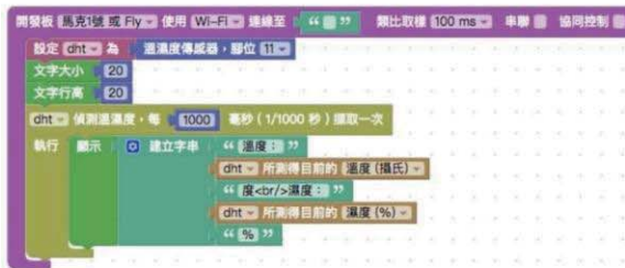
圖 2 溫濕度傳感器資料顯示程式(Webduino 官網)
