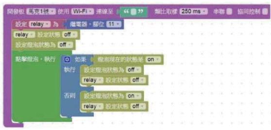
圖 7 繼電器操控程式方法(Webduino 官網)
