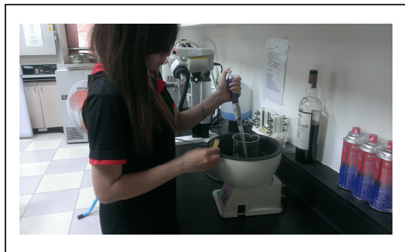
圖 1. 固定溫度融解蜂臘加混合防蚊精油情形
