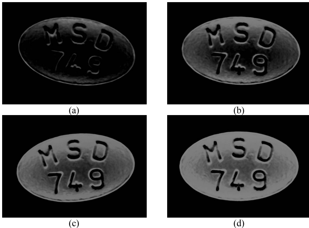
圖3不同強度側向光之藥錠取像圖：(a) 9.5V側向光強度；(b) 10V側向光強度；(c) 10.5V側向光強度；(d) 11V側向光強度
