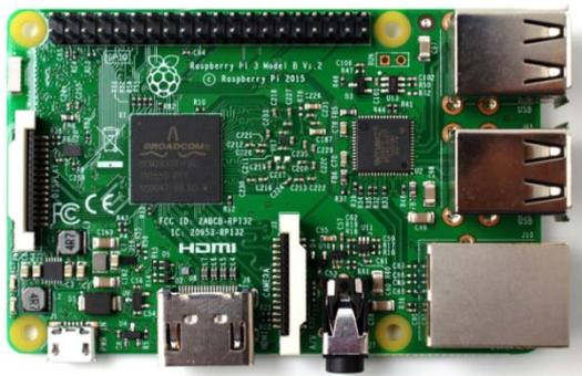
圖二、Raspberry PI 3 控制板
