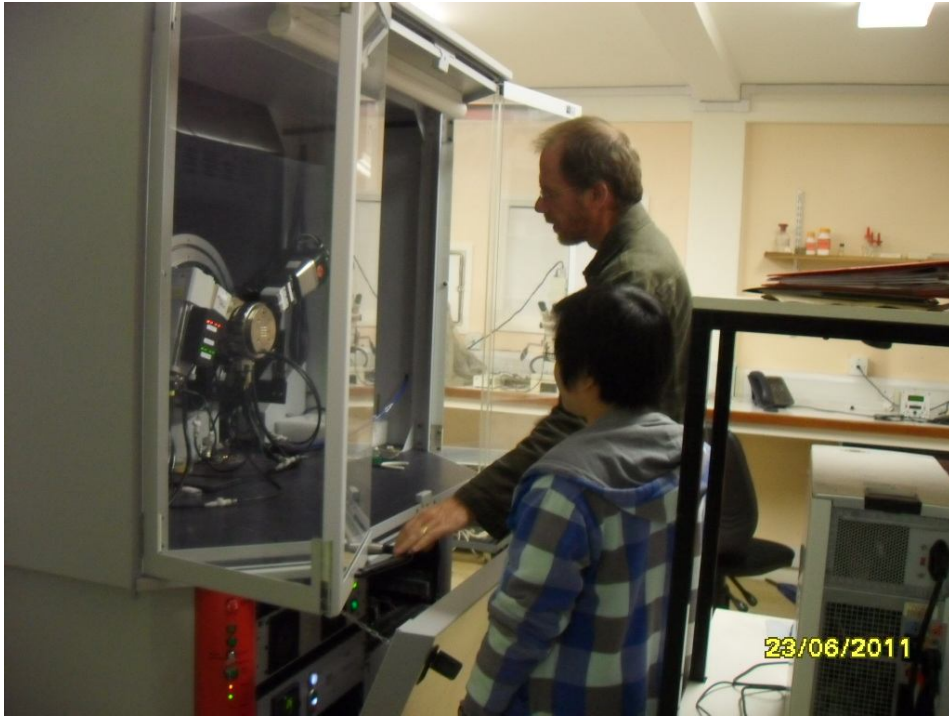
圖 3：可結合高溫、高壓實驗之 X 光粉末繞射儀，用以解決礦物之結構問題。
