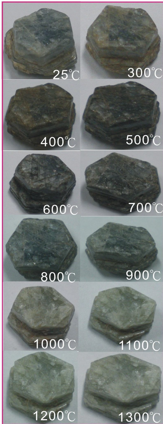
圖27：藍寶石標本之通氣高溫實驗的照片。
