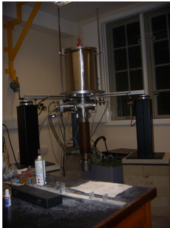
圖 4：低頻超聲波量測儀，可測量各種材料之體彈模量( Bulk modulus)等物理參數。
